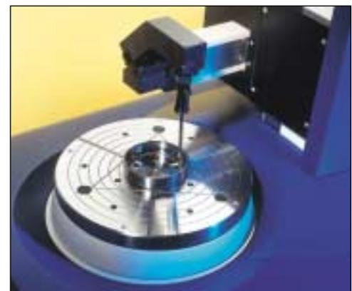
Strumento per la misurazione della rotondità Talyrond
